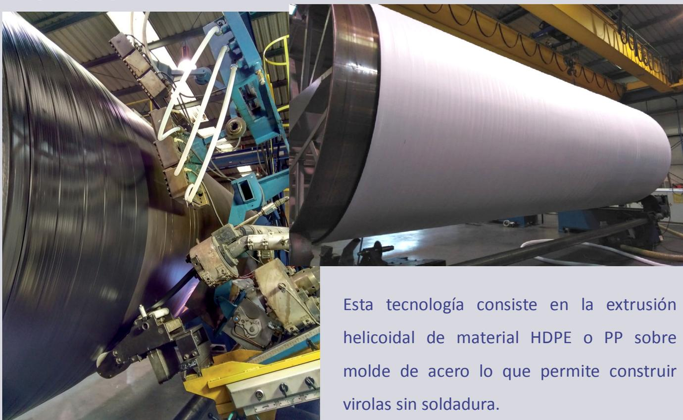
Esta tecnología consiste en la extrusión helicoidal de material HDPE o PP sobre molde de acero lo que permite construir virolas sin soldadura.
